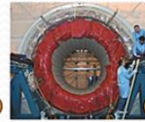
Elektromagnetiska kalorimeterna monterade i kryogeniska kärlet Foto: CERN
