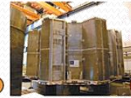
Två bilder av änd-toroidens kryogeniska kär, dels från utsidan, dels från insidan. Utan lock.
