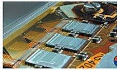
Stripsensor med skiftregistren som håller signalerna i 2,5 \mu\text{s}
